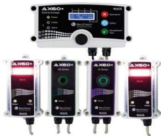
Das Ax60+ ist ein Gaswarngerät zur Überwachung von Sauerstoff und Kohlendioxid. Das Ax60+ bietet die zusätzliche Funktion eines modularen O2-Sensors, der ein Frühwarnsystem sowohl für Sauerstoffmangel als auch für Sauerstoffanreicherung umfasst. Die Sensoren für CO2 und O2 sind austauschbar und können als Teil eines Multipoint-/ Multigas- Mess- und Alarmsystems voll integriert werden.
