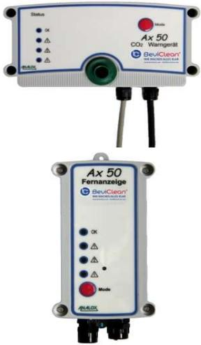
Mit dem Gaswarngerät Analox Ax50 (1-Raum) oder Ax50M (2-Raum), baumustergeprüft nach DIN 6653-2, können Sie beruhigt aufatmen, denn es bietet eine schnelle spezifische Reaktion auf Kohlendioxid. Das Gerät verfügt über drei Alarmstufen (Voralarm, Hauptalarm, Störung) und gewährleistet ein sicheres Betreten und Arbeiten in Gefahrenbereichen.
